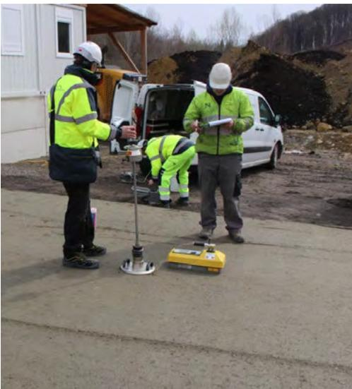
Abbildung 2: Einbaukontrolle mit Troxlersonde sowie leichtem Fallgewichtsdeflectometer
