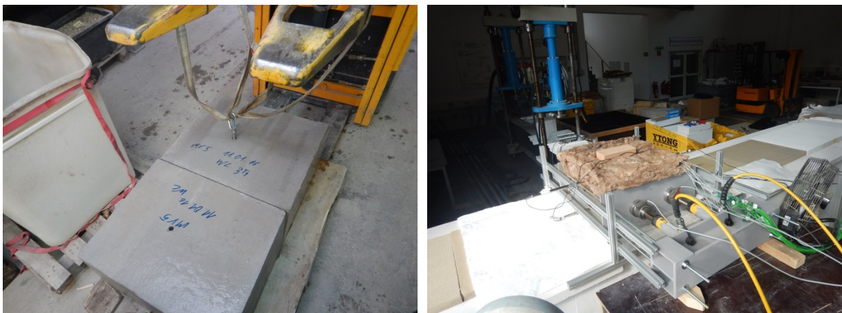
Abbildung 1: Kleinkörper (li) und Versuchsaufbau für den Brandversuch
