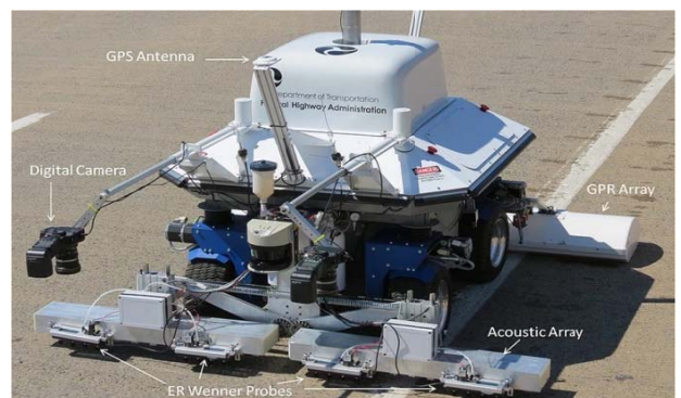
Abbildung 4: Roboterplattform mit einer Vielzahl verschiedener ZfP-Verfahren zu simultanen ortsaufgelösten Messungen. [18]
