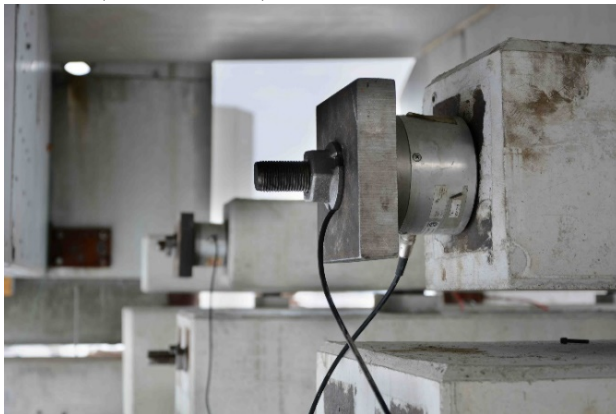
Abb. 2 Installation einer Kraftmessdose und Dehnmessstreifen an der Spannstange eines kleinen Probekörpers
