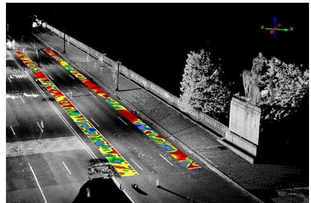
Abbildung 7: Überlagerung der Ergebnisse von Impact-Echo-Messungen mit einem 3D-Bild, erzeugt mit LiDAR. [17]
