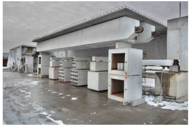
Abb. 3 Lagerung der großformatigen Betonkörper der Serien S3 und S4 im Freien (vor der Installation des Sonnenschutzes)
