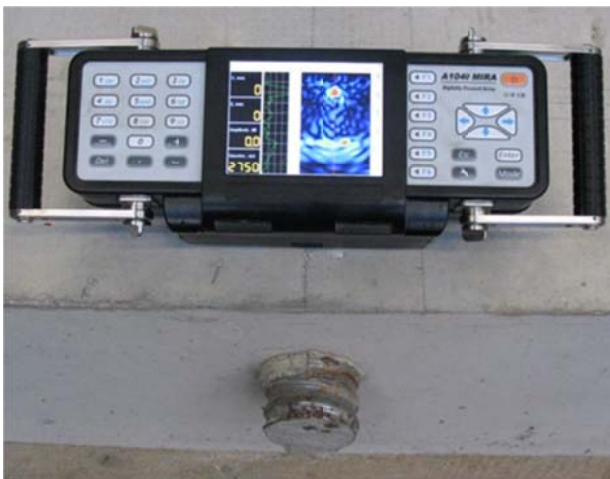
Abbildung 2: Linear-Prüfkopfarray A1040 MIRA mit SAFT-Rekonstruktionsrechnung und Bilddarstellung. [4]
