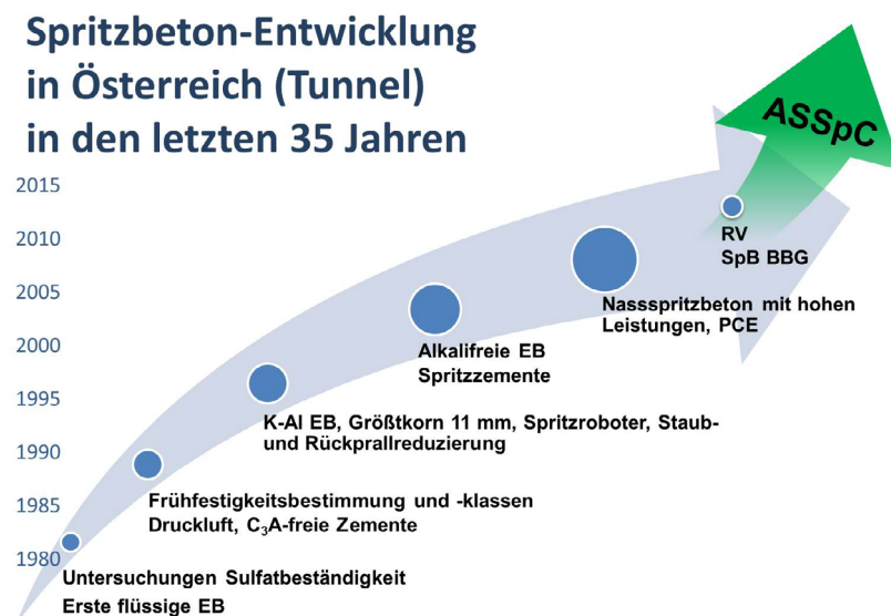
Bild 1: Die Spritzbetonentwicklung der letzten 35 Jahre in Stichworten; EB Erstarrungsbeschleuniger; Hochleistungsverflüssiger vom Typ PCE, RV reduziertes Versinterungspotential, BBG Brandbeständigkeit im Großversuch
